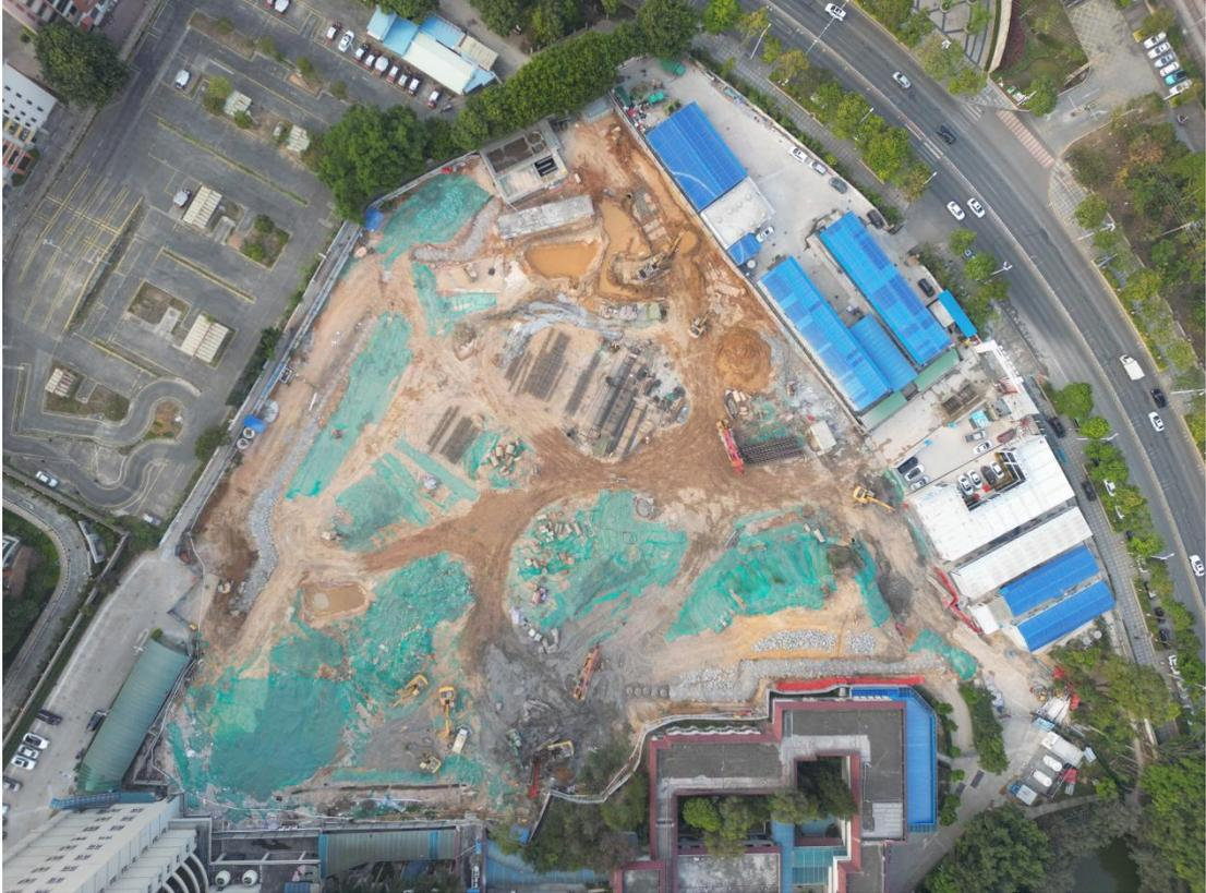
工程项目于2022年12月5日开工建设5号地下室，预计2023年第四季度5号地下室完成正负0以下主体结构，然后开始建设1号外科楼和4号停车楼。
