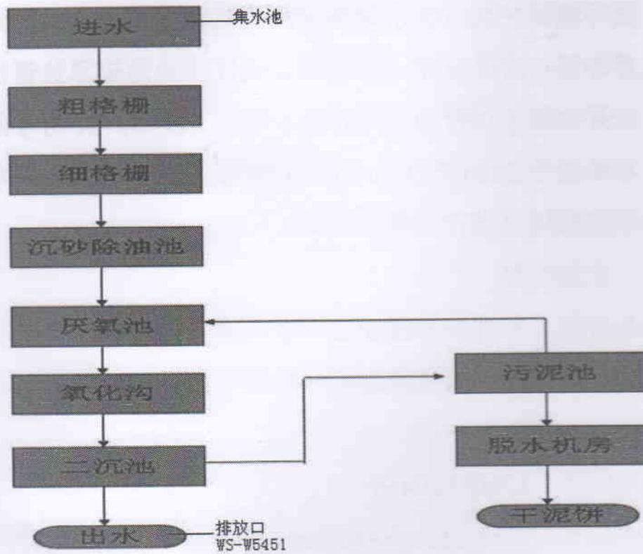
图 1 废水处理流程及监测点位
